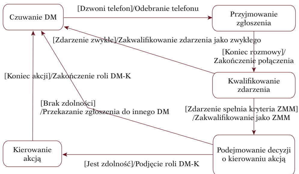
Rysunek nr 2. Maszyna stanowa zachowania reprezentująca sposób postępowania DM przy zgłoszeniu mającym charakter ZMM
