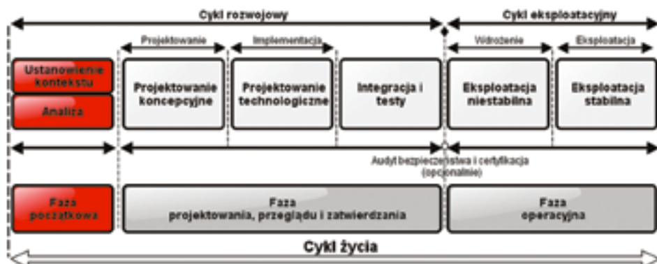
Rysunek 4. Umieszczenie fazy początkowej w modelu cyklu życia systemu zabezpieczeń
