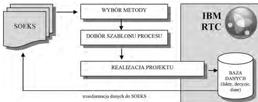
Rysunek 1. Koncepcja działania (przepływu informacji) w układzie RTC-SOEKS
